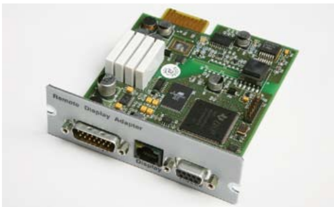
Die Schnittstellenkarte des ViewUPS-X verfügt auch über einen galvanisch getrennten Relais-Port
